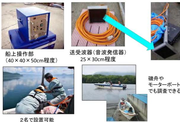
図6 パラメトリック方式音波探査装置(SES2000)
