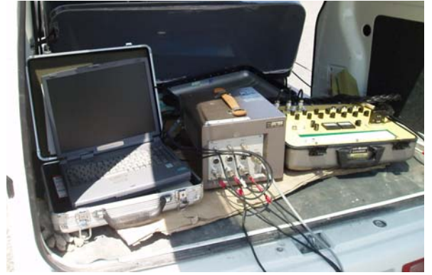
測定機器 (増幅器、測定記録収録用ノートパソコン)
