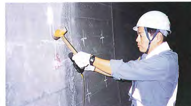
▲測定は対象物をハンマーでたたきだけ
